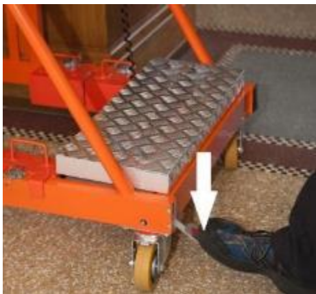
Fot. 17 Wielblokkade 125mm Drukken op het pedaal activeert de blokkade deblokkeert alle 4 de wielen
