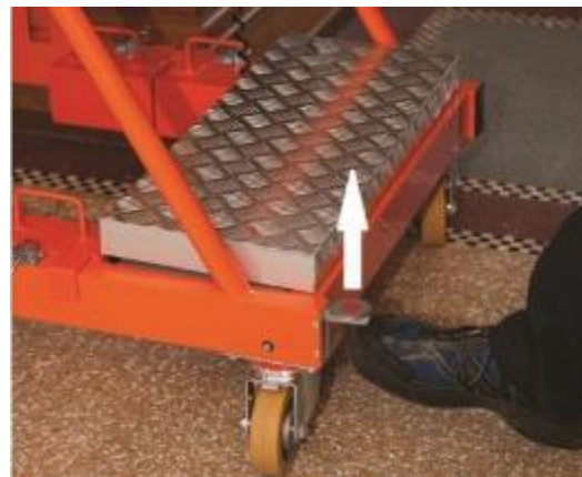
Fot. 18 Wielen deblokken Omhoogzetten van het pedaal
